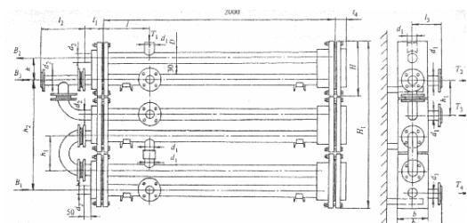
**Рис. 6. Водоподогреватель блочного типа по ТУ 400-28-132-90**
