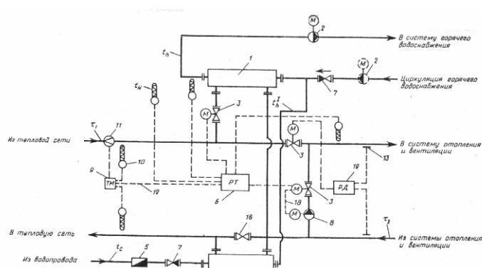
Рис. 3. Двухступенчатая схема присоединения водоподогревателей горячего водоснабжения для промышленных зданий и
