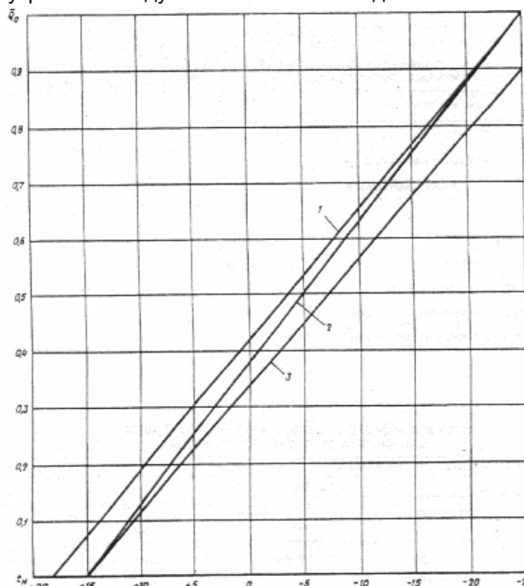
Рис. 1. Графики относительного изменения теплового потока на отопление  $Q_0$ , в зависимости от наружной температуры  $t_h$  для разного типа потребителей и способов авторегулирования
