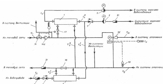
**Рис. 5. Двухступенчатая схема присоединения водоподогревателей горячего водоснабжения в ИТП с водоструйным элеватором и автоматическим регулированием расхода теплоты на отопление (пример учета теплоты по водомерам)**
