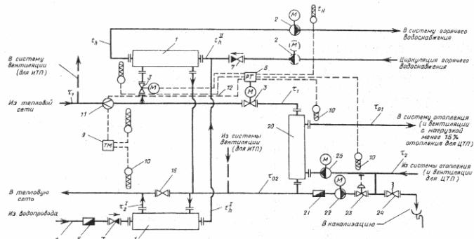
**Рис. 4. Двухступенчатая схема присоединения водоподогревателей горячего водоснабжения для жилых и общественных зданий и жилых микрорайонов с независимым присоединением систем отопления в ЦТП и ИТП**
