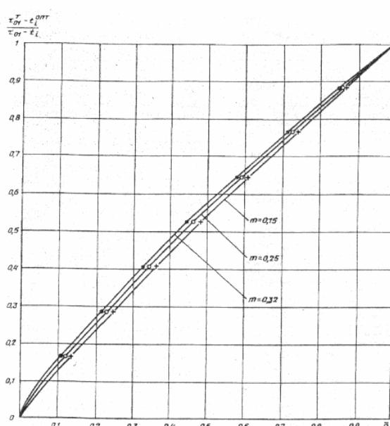
Рис. 2. Графики изменения температурного критерия системы отопления по температуре воды в подающем трубопроводе
