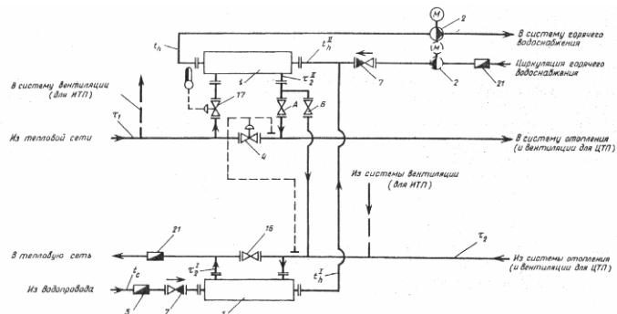
**Рис.8. Двухступенчатая схема присоединения водоподогревателей горячего водоснабжения с зависимым присоединением систем отопления при отсутствии регуляторов расхода теплоты на отопление в ЦТП и ИТП**
