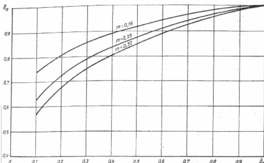
Рис. 5. Графики изменения относительного расхода воды в однотрубной системе отопления при количественно-качественном регулировании сетей отопления  $t_{01}=120$  °С, а для ЦТП с зависимым присоединением —  $t_{01}=150$  °С.
