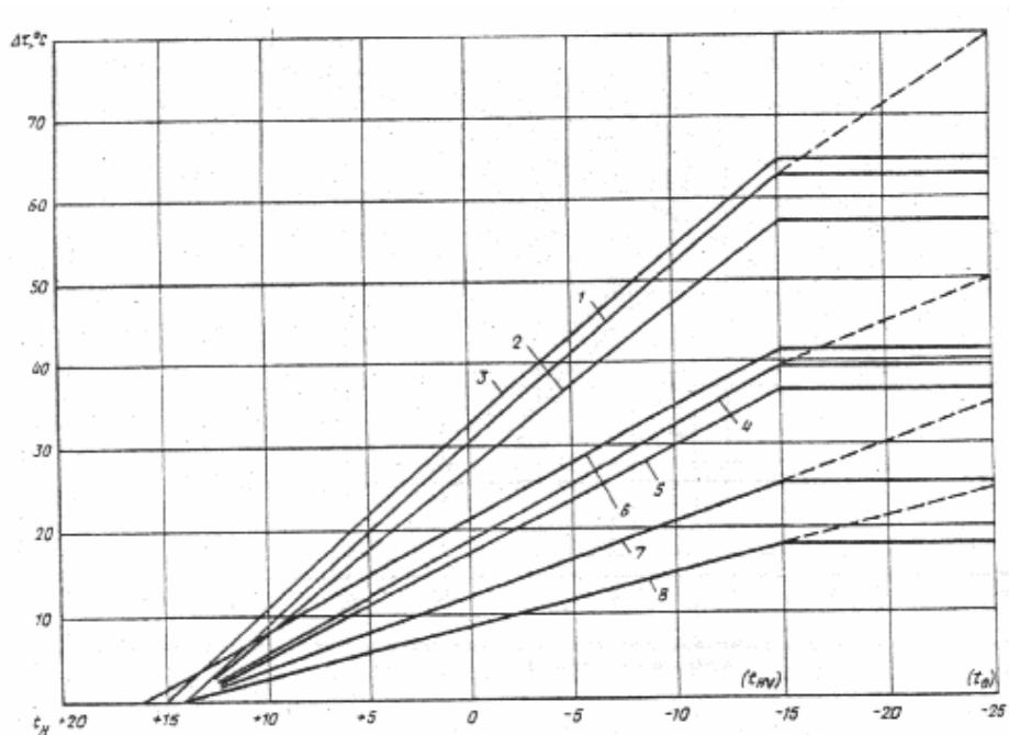
Рис. 6. Графики изменения разности температуры воды в подающем и обратном трубопроводах системы отопления  $\Delta t$  в зависимости от  $t_n$
